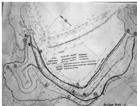
Slika 4. Projektovano narezivanje terasnih ravni na brani "Kaluđerica" glavnog odlagališta flotacijske jalovine "Valja Fundata"
