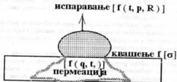
Slika 1. Model kontaminacije tečno-čvrsto; t - temperatura; p - napon para; R - Reynolds-ov broj; q - koeficijent difuzije; δ - površinski napon
